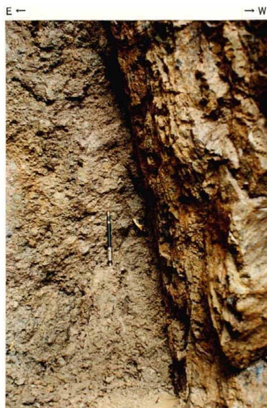
同左断層面近傍の拡大 断層面は明瞭でシャープである。
