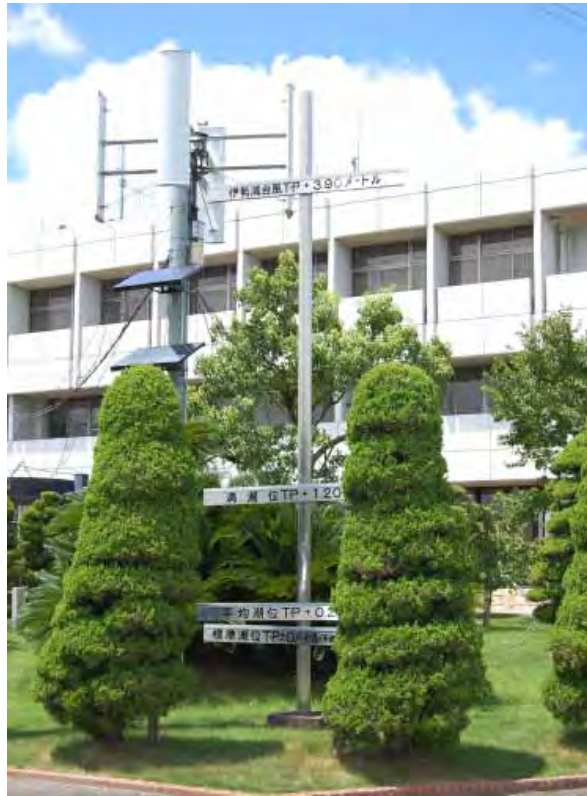
写真－3 三重県桑名市役所長島町総合支所(旧桑名郡長島町役場)の伊勢湾台風時水位及び潮位の表示（平成22年8月撮影）
