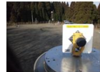
TS 観測のため方位点に目標を設置
