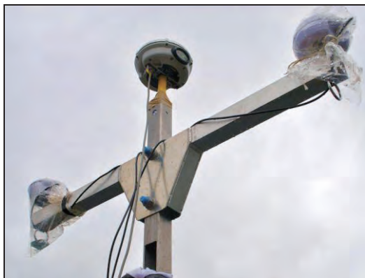
写真-17 位置計測装置
