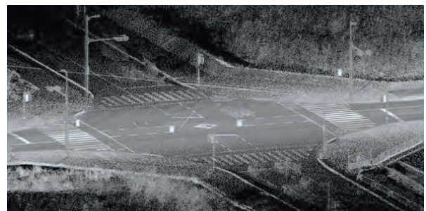
図-1 3次元レーザ点群データ
