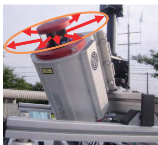
写真-2 可動式レーザスキャナ (RIEGL VQ-250)
