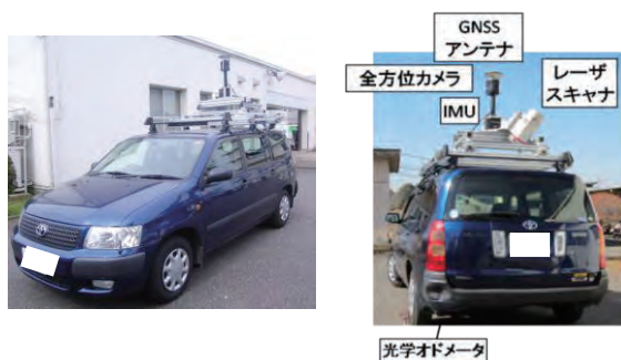
写真-1 本研究に用いた MMS
