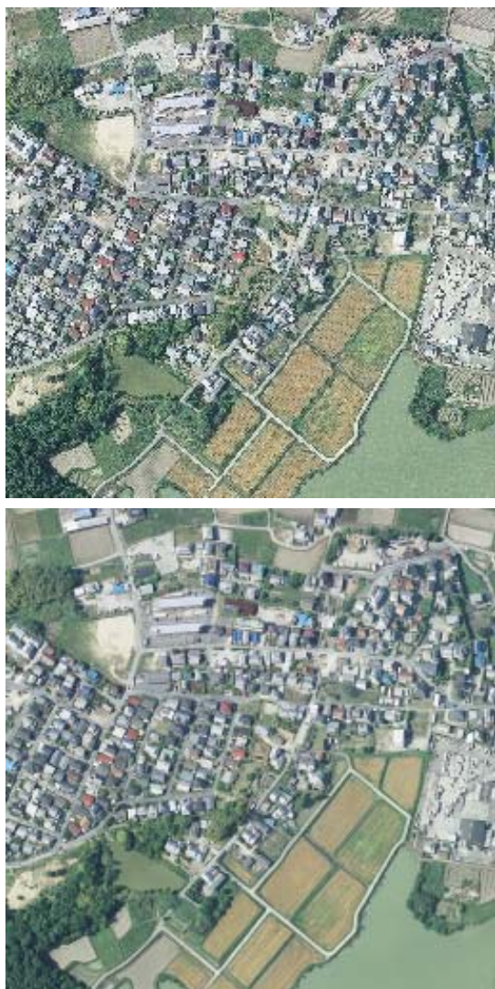
図-2 直接的作成—オリジナルタイルと配信タイルの解像度の乖離が大きい場合(上)と小さい場合(下)
