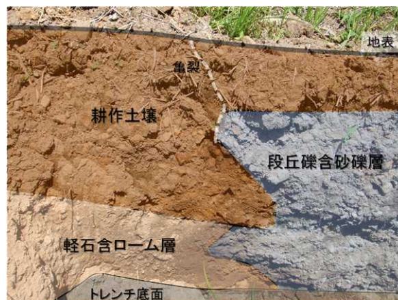
図-9 雪坪地区の水田トレンチの北西壁面解釈図
