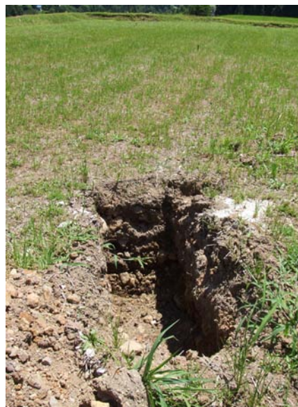
写真-19 雪坪地区の水田に掘られた小さなトレンチ（写真撮影位置は図-8 参照）。長さ約 1.5m, 幅約 0.5m, 深さ約 1m で、長辺が北西－南東方向。
