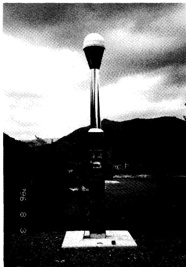
図-2 収納箱を開いた電子基準点
