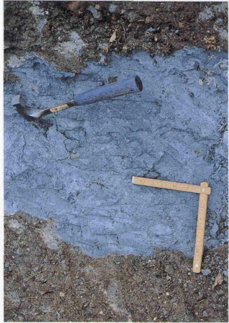
写真-4 地すべり粘土の露頭 (1997年5月30日撮影)
