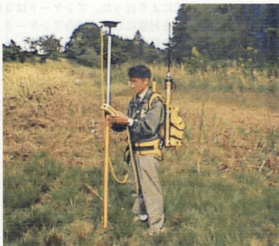
図-7 RTK-GPS測量中
