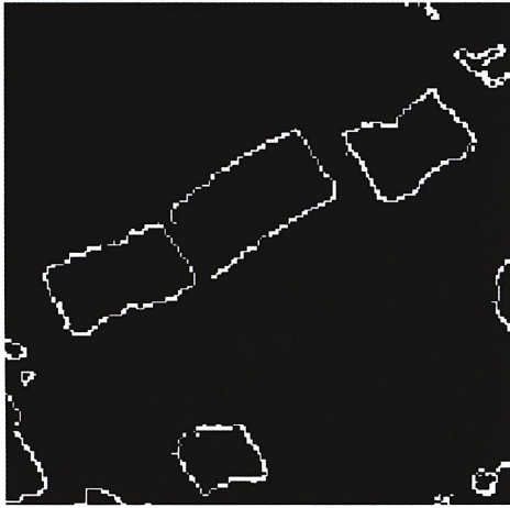
図一 5 エッジ抽出手法によって検出された、建物縁（左図の白い部分）。右図は検出されたエッジをベクトル変換して得られた建物外形。
