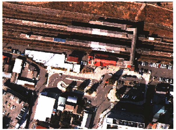
図－４（左）二時期（平成８年及び平成１１年）の画像から高さが変化している部分を取り出した画像。 （右）平成７年に撮影された同じ地域の画像。
