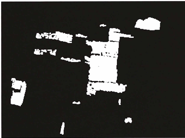
図－４（左）二時期（平成８年及び平成１１年）の画像から高さが変化している部分を取り出した画像。 （右）平成７年に撮影された同じ地域の画像。
