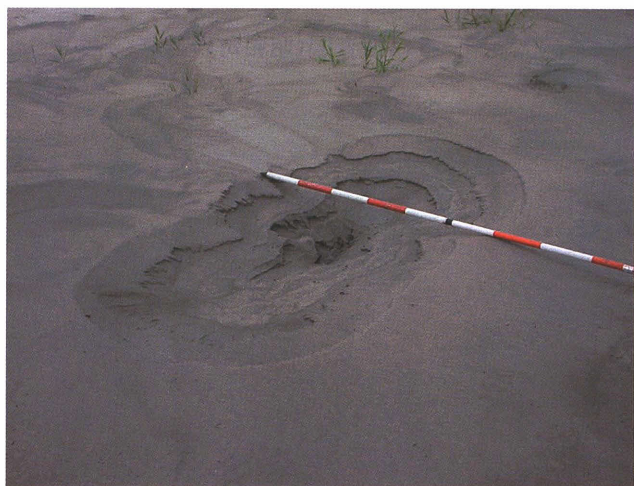
写真－4 大きな噴砂口(A-4)
