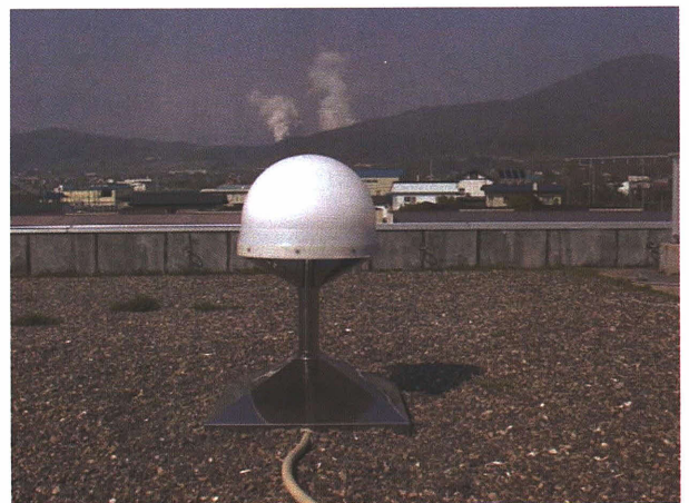
写真-2 GPS機動連続観測装置(M漁協測点)
