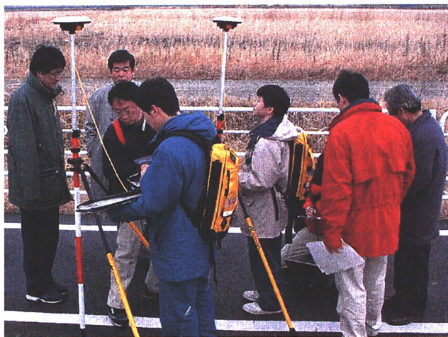
写真－2 仮想基準点方式（双方向・片道通信）による観測風景
