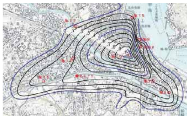
地盤沈下変動を2. 5万分の1地形図上に等値線表示している各イメージ図：宮城県提供
