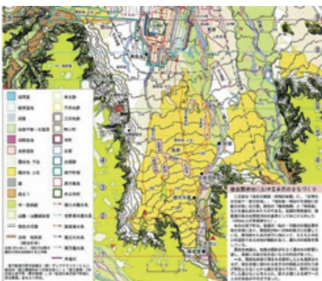
基盤地図情報上に、地形分類図（昭和60年版）を幾何補正し、現在の用水路網、等高線などを重ね合わせた
