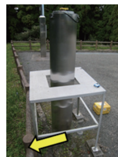
写真-6 コロケーション用ピラー 1（始良） 矢印の向きは、法面方向になる
