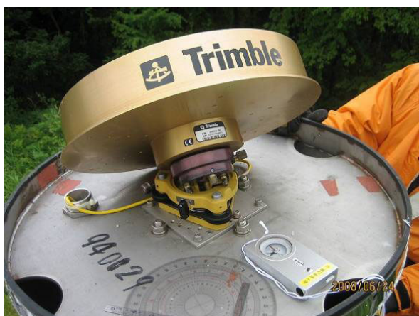
写真－3 傾いたアンテナと脱落した回転台座
