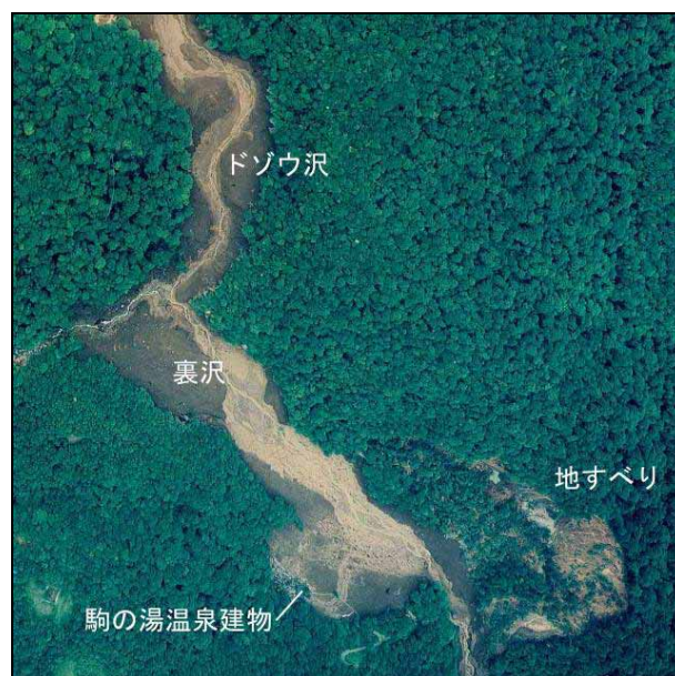
写真－7 駒の湯を直撃した土石流と裏沢を閉塞した地すべり 国土地理院撮影空中写真 C2A-0840 に加筆
