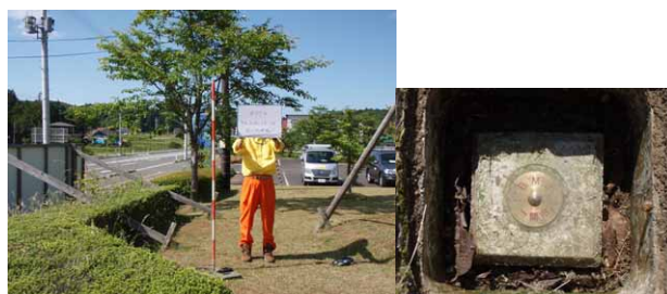
写真-1 正常を確認した BM. 4 地下埋設で保存も良好
