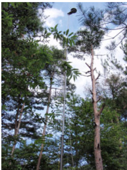
写真-3 GPS アンテナタワー（15m）を用いた観測点
