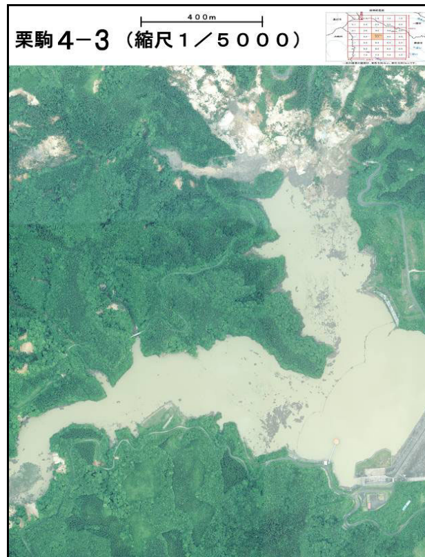
図－8 簡易オルソ画像図の一部（荒砥沢ダム） （縮尺 1/5,000 を 33%縮小）
