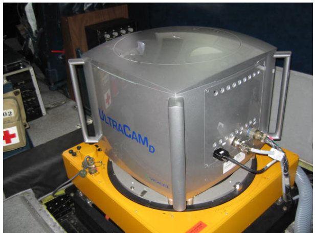
写真－2 SU (機体設置時)
