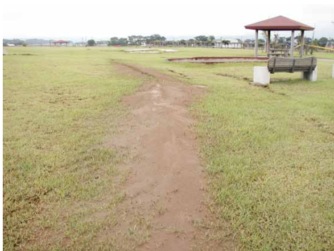
図-15 鯖石川河川改修記念公園の噴砂（図-12 の C2, 図-16 の B）
