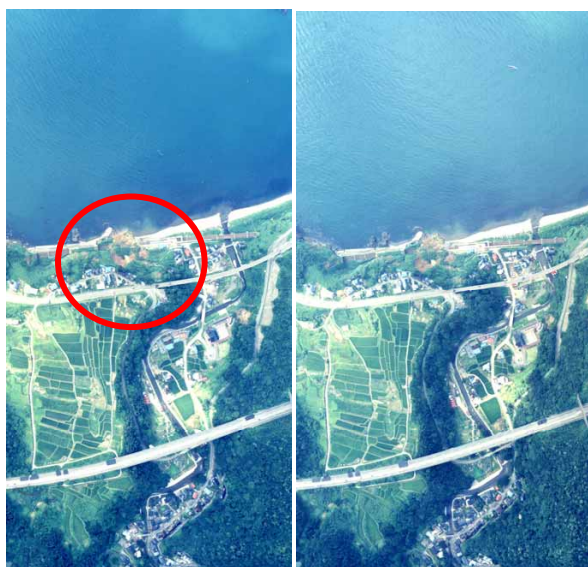
写真-13 斜面崩壊（青海川駅付近）（立体視可能）
