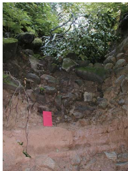
図－7 マサ土と花こう岩類角礫の成層構造
