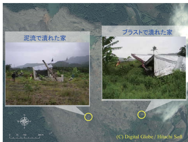
図－9 QuickBird 画像で確認できる建物被害
