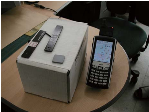
写真-6 インテリジェント基準点のタグリーダー
