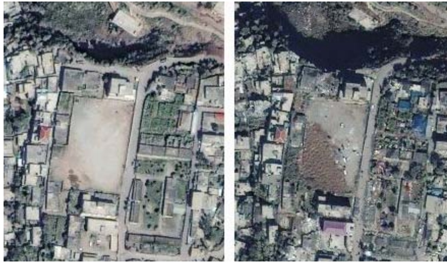
図 5 図 3 の「8」に示した地盤の液状化が疑われる地点 Fig.5 The site “8” in Fig.3 where liquefaction may occur.
