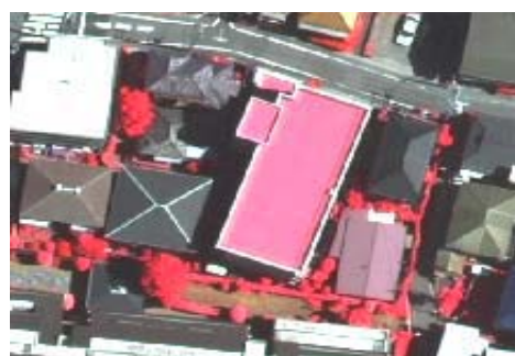
図-20 植生と似た近赤外線の反射特性を示す人工構造物の例
