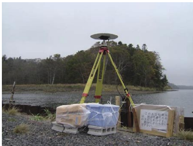
写真-3 ベンチマーク設置のためのGPS観測
