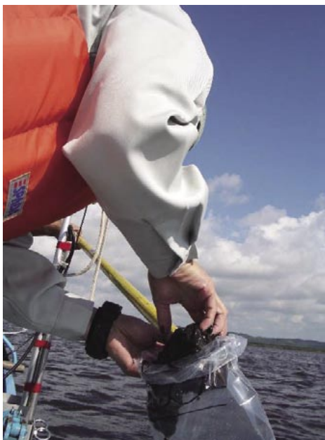
写真-7 槍式採泥器による底質採取
