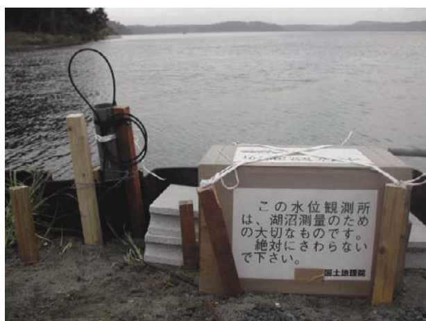
写真-4 水位観測所
