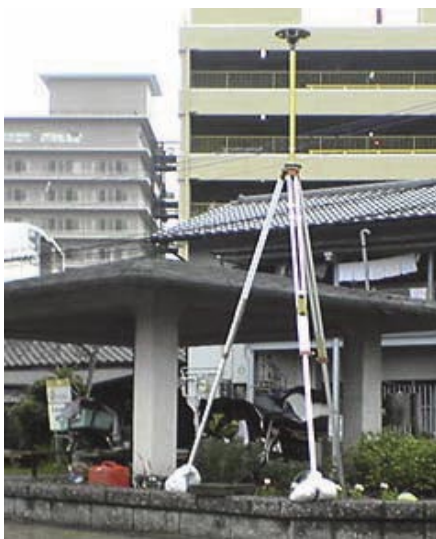
写真－４ 街区基準点測量風景 （左：アンテナタワーによる GPS 観測 右：TS の観測（現地最終確認検査））
