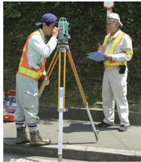
写真－４ 街区基準点測量風景 （左：アンテナタワーによる GPS 観測 右：TS の観測（現地最終確認検査））
