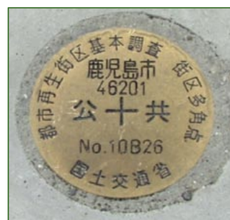
写真-2 街区多角点標識
