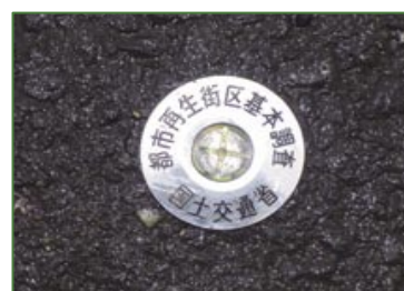
写真-3 街区補助点標識
