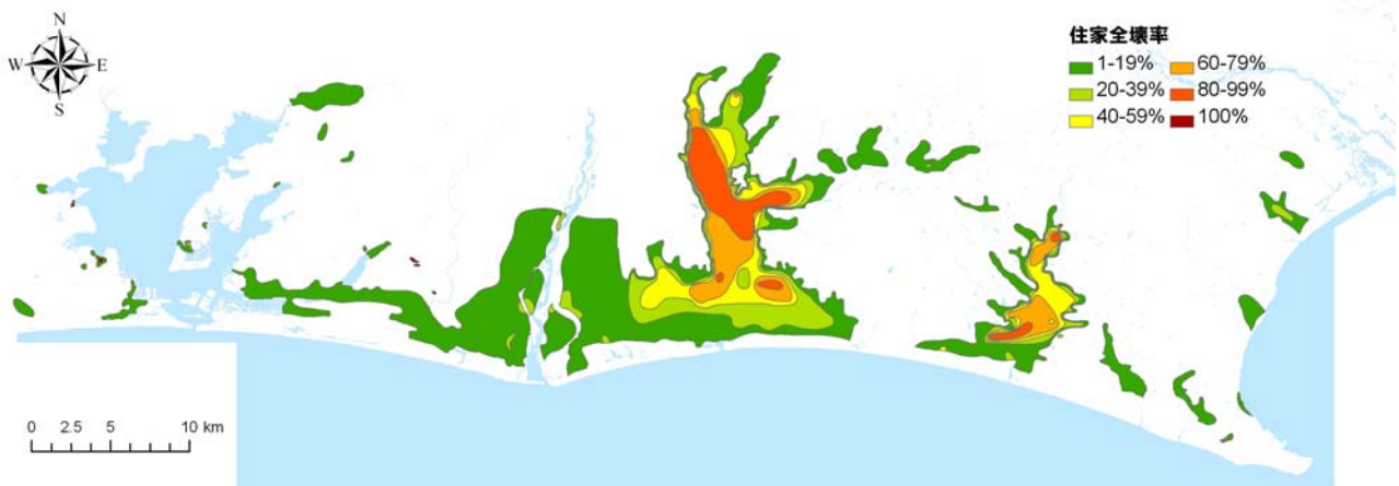
図－9 遠州灘沿岸の1944年東南海地震による住家全壊率の等被害線図（大庭：1957による） （背景は土地条件図の水部）
