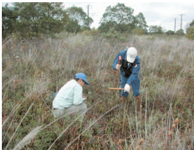
写真-2 簡易ボーリング調査
