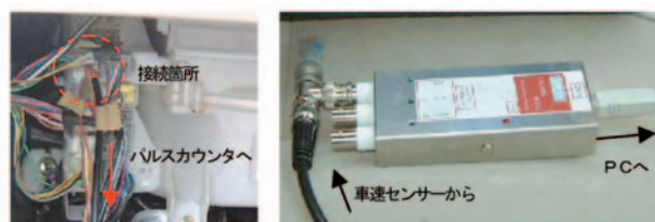
図ー3 車速パルス配線（左）及びパルスカウンタ（右）
