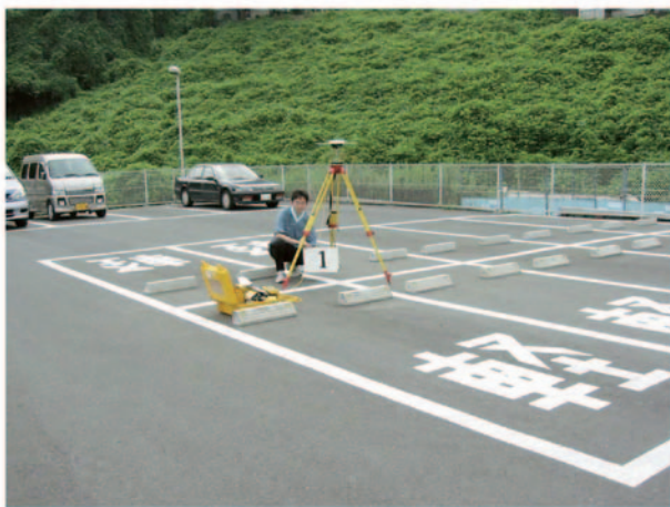
図-4 ファストスタティック GPS 測量
