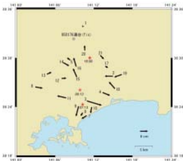
図-13 三角点の変動量 電子基準点「涌谷」固定
