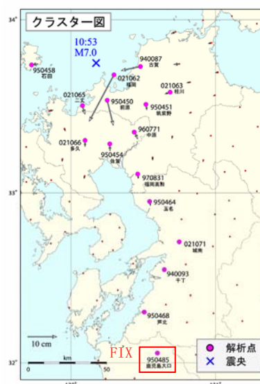
図－7 福岡県西方沖地震時の解析クラスタ図。F2解から求めた水平変動量をベクトルで示す。
