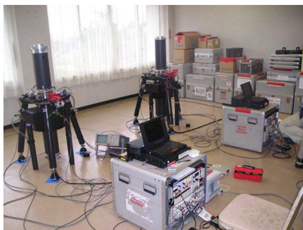
写真－3 筑波山山麓における FG5 (#203) の問題の原因調査 右が FG5 (#203)、左が FG5 (#201)。2 つは同じタイプの絶対重力計である。
