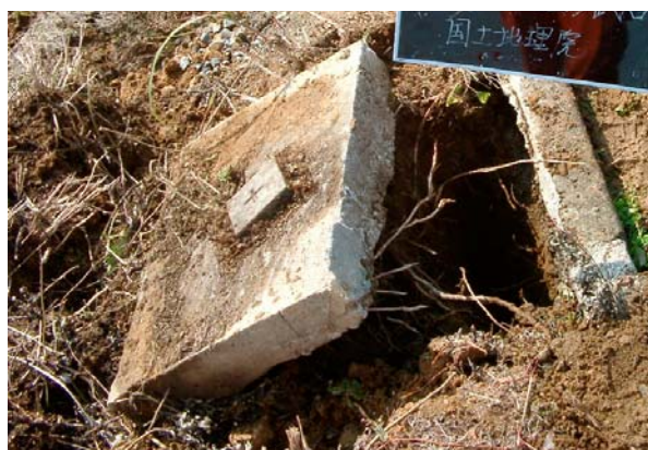
写真－6 崩れ落ちた三角点（小国町）
