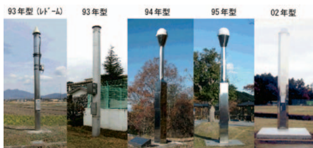
写真－3 アンテナ架台形状
