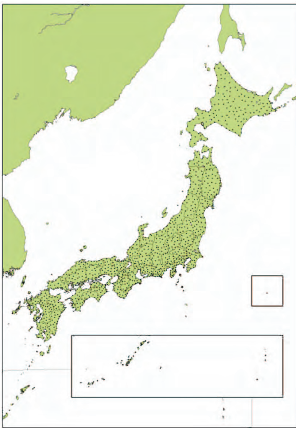
図-12 電子基準点（1,200点）配点図
