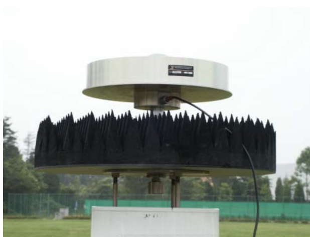
写真－2 電波吸収材の設置
