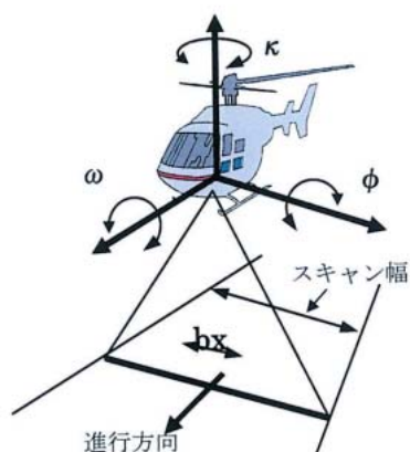
図-13 レーザスキャナのキャリブレーションの各要素
