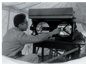
写真－9 ジョブメータII型による辺長測量
