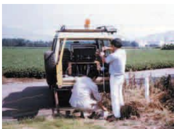
写真-14 慣性測量作業 (計測点における偏心量測定)
