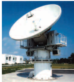
写真-16 可搬型 VLBI 観測装置 (アンテナ径 5m)
