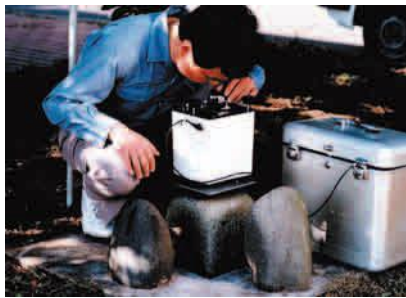
写真-24 ラコスト重力計による測定
